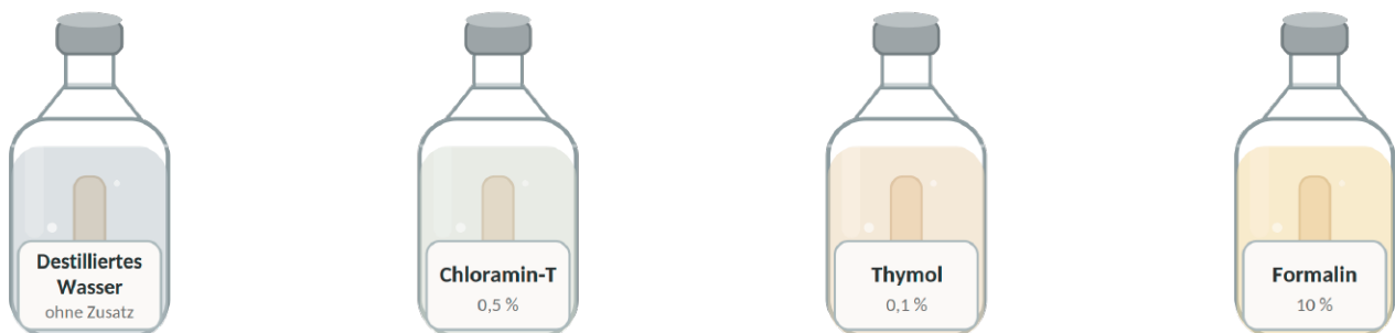
►1 Schematische Darstellung eines lagernden Prüfkörpers in destilliertem Wasser, Chloramin-T (0,5 %), Thymol (0,1 %) und Formalin (10 %).
