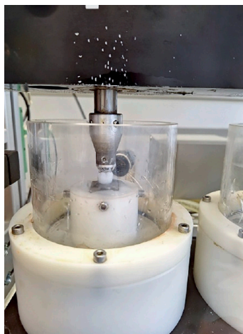
► 3 Zwei-Körper-Verschleißtest im Kausimulator.
