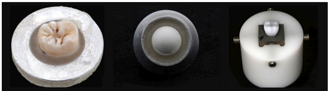
► 2 Menschlicher Zahn (links) und Steatitkugel (mitte) in Prüfkörperhalterung, Krone (rechts) auf Cobalt-Chrom-Stumpf.
