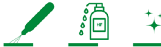
Abbildung 2: Prüfkörpervorbereitung durch Strahlen, Ätzen mit Flusssäure und Polieren.
