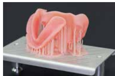
Generativ hergestellte Prothesenbasen aus V-Print dentbase
