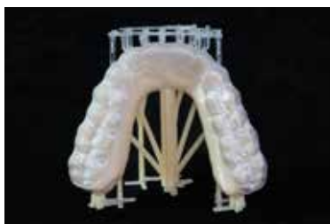
Schienen-Modellkombination aus dem 3D-Drucker aus V-Print model 2.0 und V-Print splint
