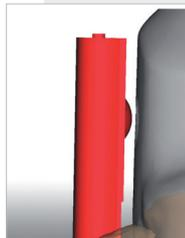
**3.** Der digitale Platzhalter wird tangential an die Primärkrone angelegt, und der Zentrier-Knopf exakt in der Eingriffsmulde positioniert.
