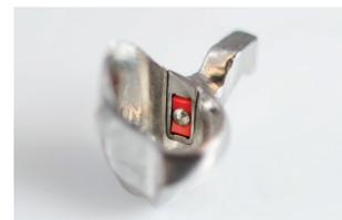
**9.** In das Sekundärteil wird abschließend das Friktionselement TK-Snap oder TK-Fric eingesetzt.
